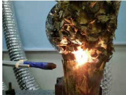
Demonstrasi pemotongan tandan buah kelapa sawit menggunakan laser
